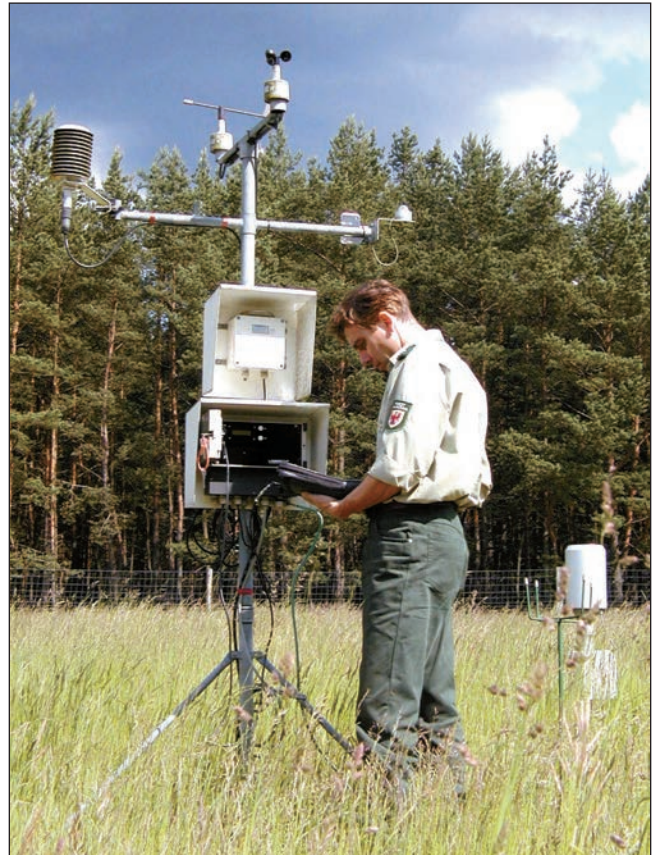
Übertragung von Klimadaten an einer Level II Freiland – Messstelle (1203)
