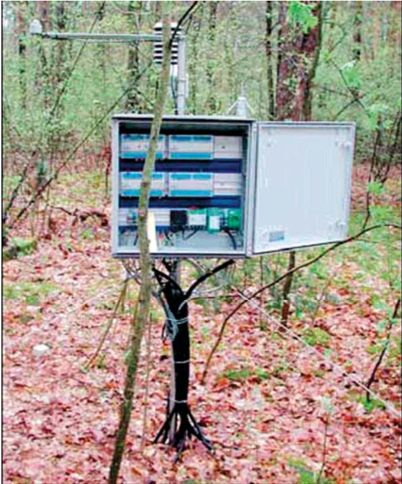
Station zur Datenerfassung und -fernübertragung auf der Level-II-Dauerbeobachtungsfläche Berlin- Grunewald
