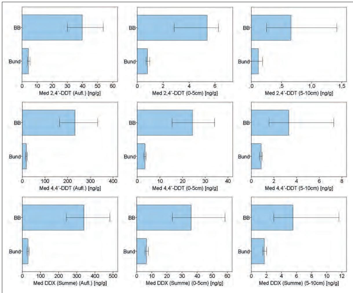
Abb. 3: Mediane und 95%-Konfidenzbereiche der Gehalte der Pestizide Dieldrin, Hexachlorbenzol (HCB), Hexachlorcyclohexan ( $\alpha$ -HCH,  $\beta$ -HCH,  $\gamma$ -HCH), DDT und Metabolite (DDE, DDE) sowie Summen der HCH bzw. DDX in Humusauflage, 0-5 cm und 5-10 cm Tiefe im Vergleich von bundesweiter und brandenburgischer BZE-Stichprobe (Stoffe mit Median  $\leq$  Bestimmungsgrenze sind nicht dargestellt)
